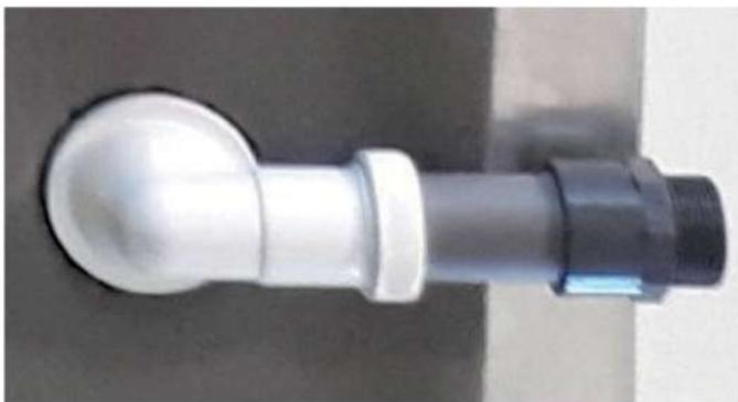
Las salidas de condensados están realizadas en tubo de PVC de diámetro 32 y 40 mm según modelo y una salida rosca macho de 1¼".
